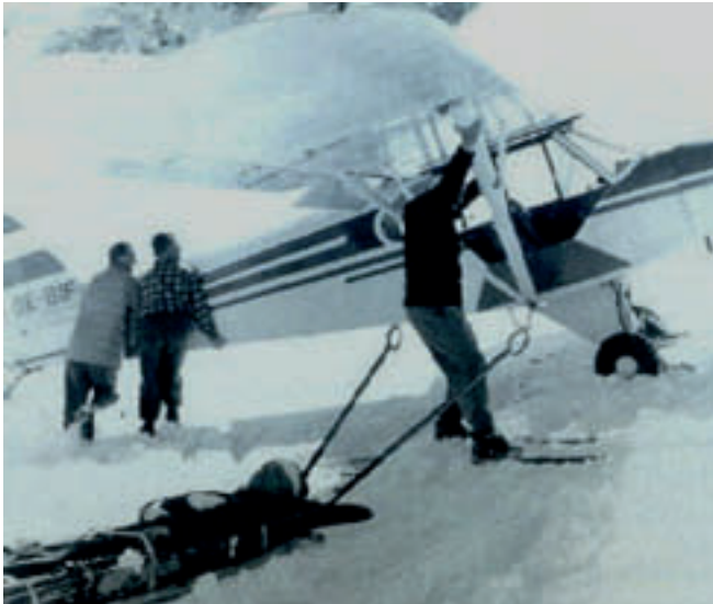
Flächenflugzeug Piper, ausgerüstet mit einer Schianlage für Schneelandungen
