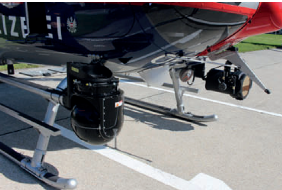
FLIR-Kamerasystem und Suchscheinwerfer SX16 Night Sun
